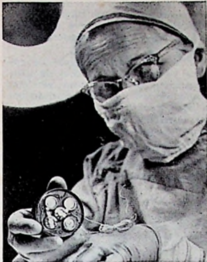
In de geneeskunde wordt dankbaar gebruik gemaakt van de transistor. Op deze foto een hartstimulator ontwikkeld door General Electric.
